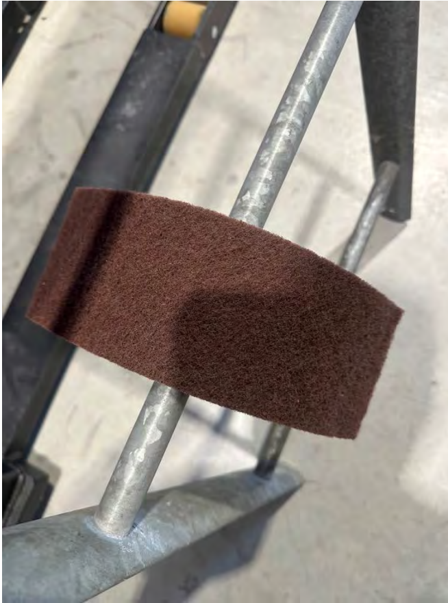
Entfernung der groben Verschmutzungen mittels Schleifvlies.
